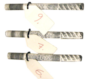
Galvaniserade testprover, 480 timmar efter det neutrala saltspraytestet.
