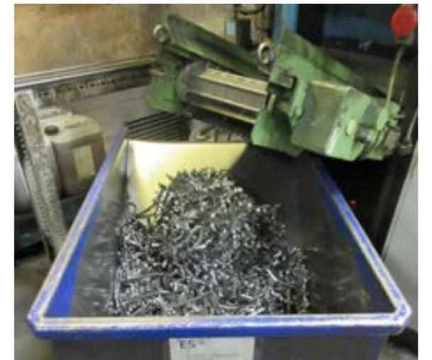
**Bild:** Stahlschrott nach dem Bohren, der darauf wartet, an ein Stahlwerk zurückgeschickt und erneut in den Materialkreislauf zurückgeführt zu werden.
