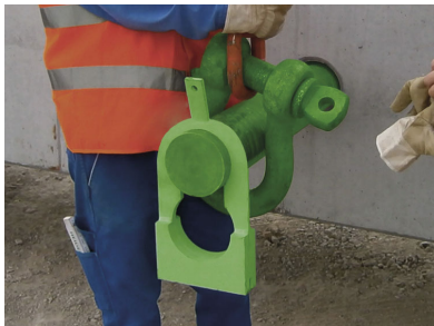
Figur 23. Stropper fastgjort med sjækler.
