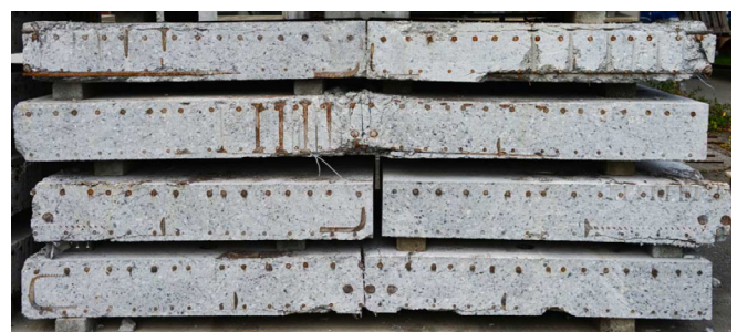
Abbildung 4. Prüfungen des PSB PLUS Durchstanzbewehrungssystems am EPFL Lausanne in der Schweiz
