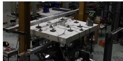
Abbildung 4. Prüfungen des PSB PLUS Durchstanzbewehrungssystems am EPFL Lausanne in der Schweiz
