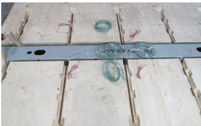
Abbildung 2. Querbewehrung gewährleistet die Lastübertragung.
