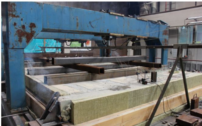
Abbildung 7. Prüfkörper für den 90-minütigen Brandversuch mit Belastung. Die Lastanordnung simulierte eine Konstruktion aus DELTABEAM® und CLT-Platten mit 8 m CLT-Spannweite, 1,7 kN/m 2 ständiger Last und 5 kN/m 2 Verkehrslast ( \psi_1=0,7 ). Der festgelegte Faktor \psi_1 entspricht dem verwendeten Faktor für Gemeindegebiete, Einkaufszonen und Verkehrszonen der Kategorie F.
