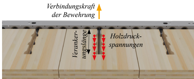
Abbildung 12. Die Kraft im Querbewehrungsstab erzeugt Druck in den Nuten.
