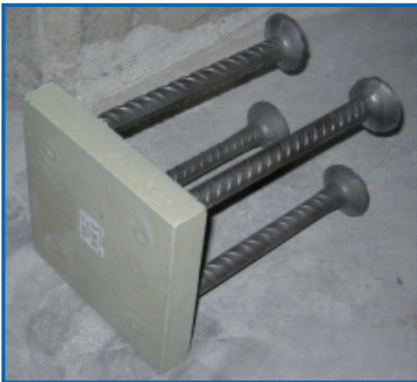
Figura 10. Ejemplos de pletinas de anclaje tipo JPL para grandes cargas. Los anclajes de las pletinas JPL tienen doble soldadura: en el perímetro del anclaje y en la base perforada de la pletina
