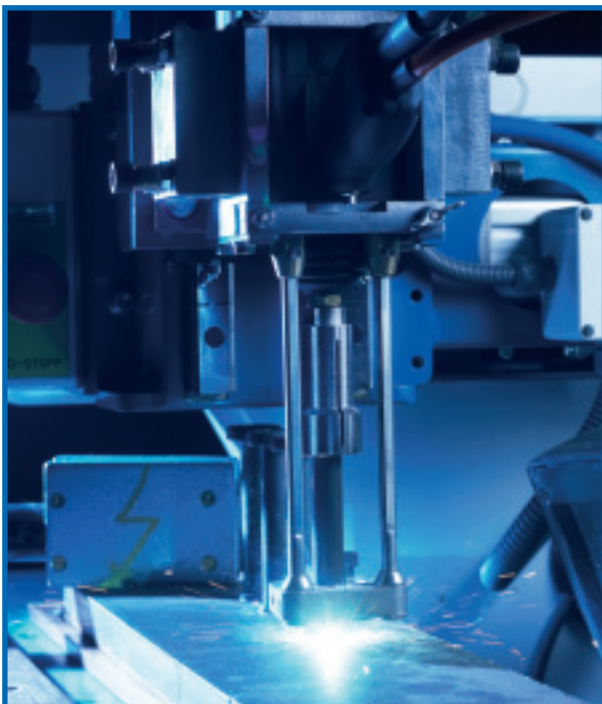
Figura 6. Máquina de soldadura soldando los anclajes de una pletina
