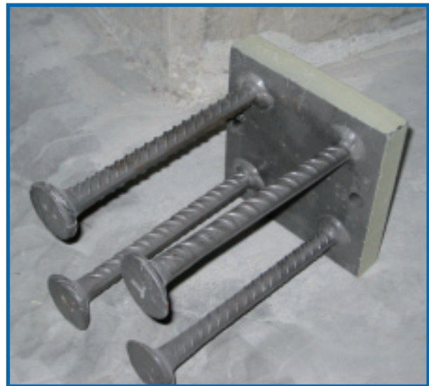
Figura 10. Ejemplos de pletinas de anclaje tipo JPL para grandes cargas. Los anclajes de las pletinas JPL tienen doble soldadura: en el perímetro del anclaje y en la base perforada de la pletina
