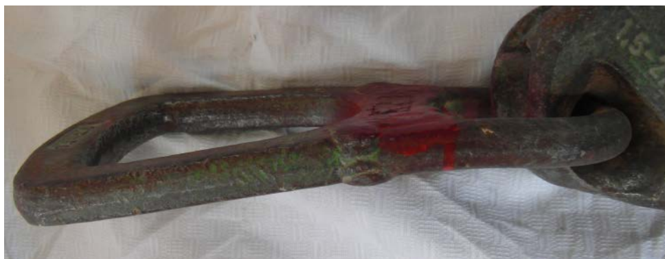
Obrázek 58. Poškozený kulový kloub / únava s trhlinami.
