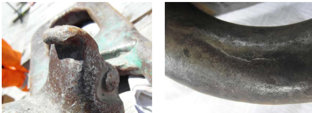
Obrázek 58. Poškozený kulový kloub / únava s trhlinami.
