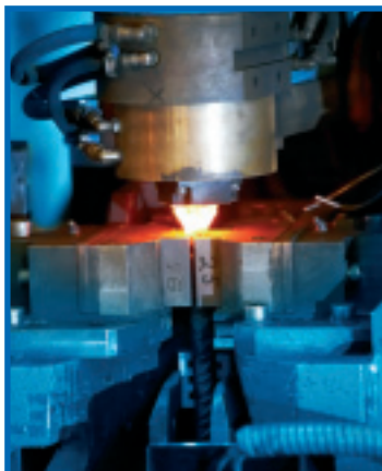
Figura 1. Máquina fabricando un tornillo HPM/L
