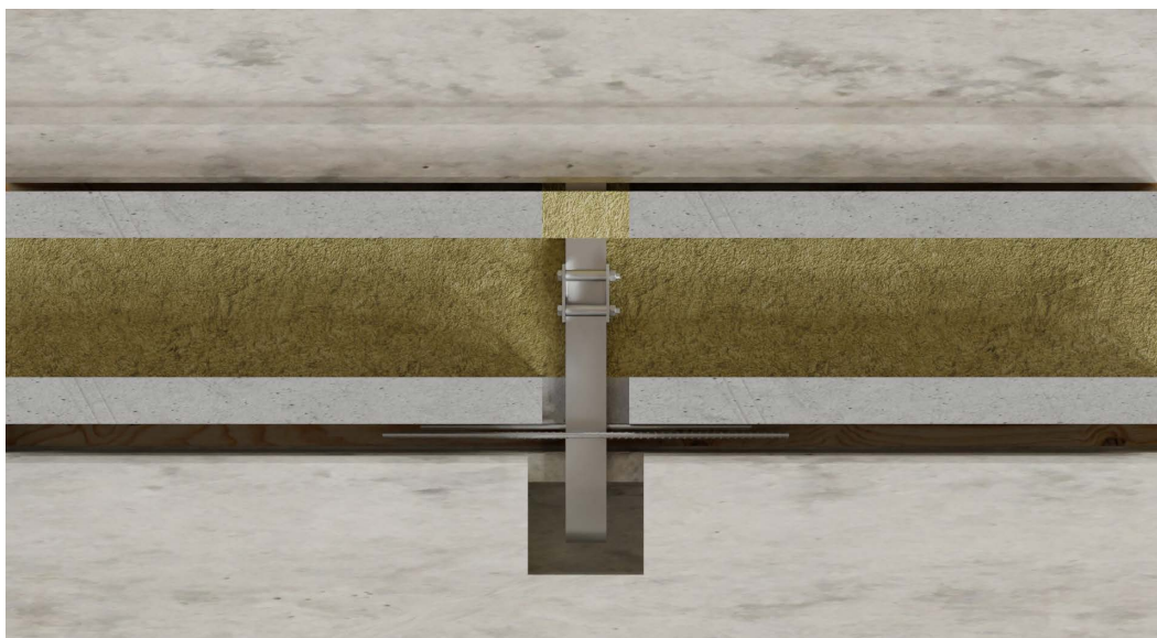
Kuva 15. Liitos yläpuolelta ennen valua.
