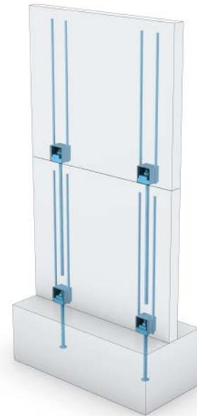
*Abbildung 2. Verbindung von SUMO® Wandschuhen mit HPM®, bzw. PPM® Ankerbolzen*
