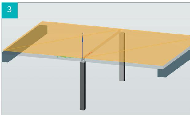
3. Länge und Art des Trägers sowie Deckensystem und Spannweiten angeben
