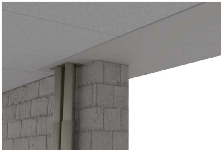
7. ábra: Alátámasztás DELTABEAM® falvégre ülése esetén.
