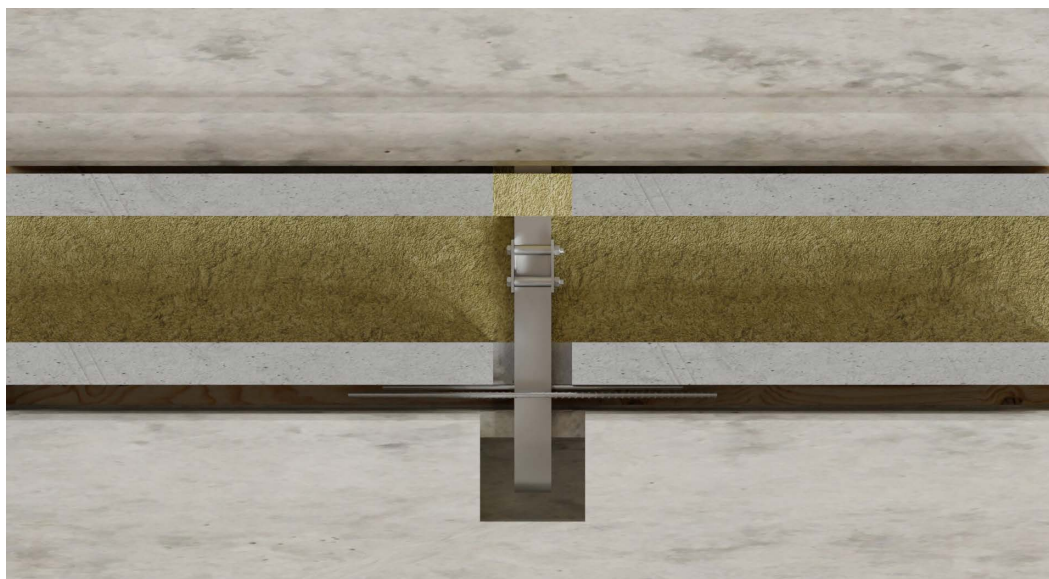
Kuva 15. Liitos yläpuolelta ennen valua.
