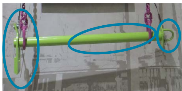
Figura 37. Area di ispezione del perno di sollevamento.
