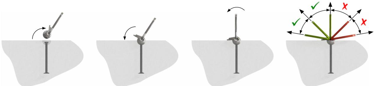
Figura 23. Dettaglio di connessione del maniglione di sollevamento KKL e dell'inserto di sollevamento KK senza perno di sicurezza.
