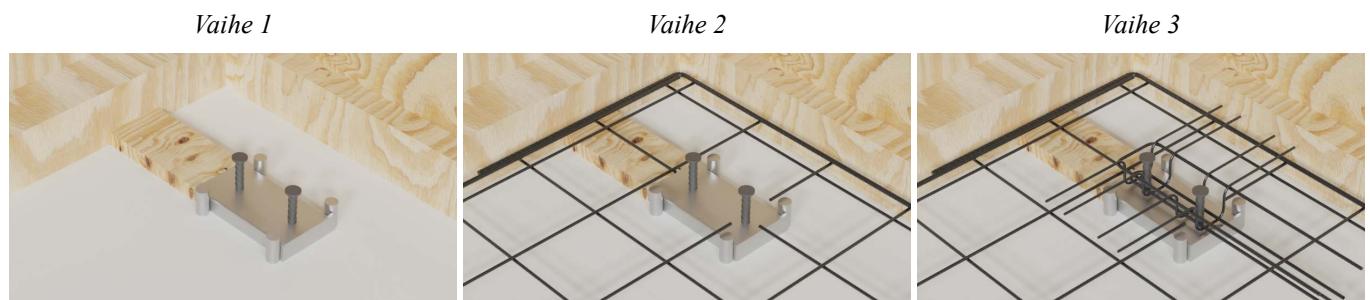
Kuva 18. Kaiteen valu julkisivupinta ylöspäin.
