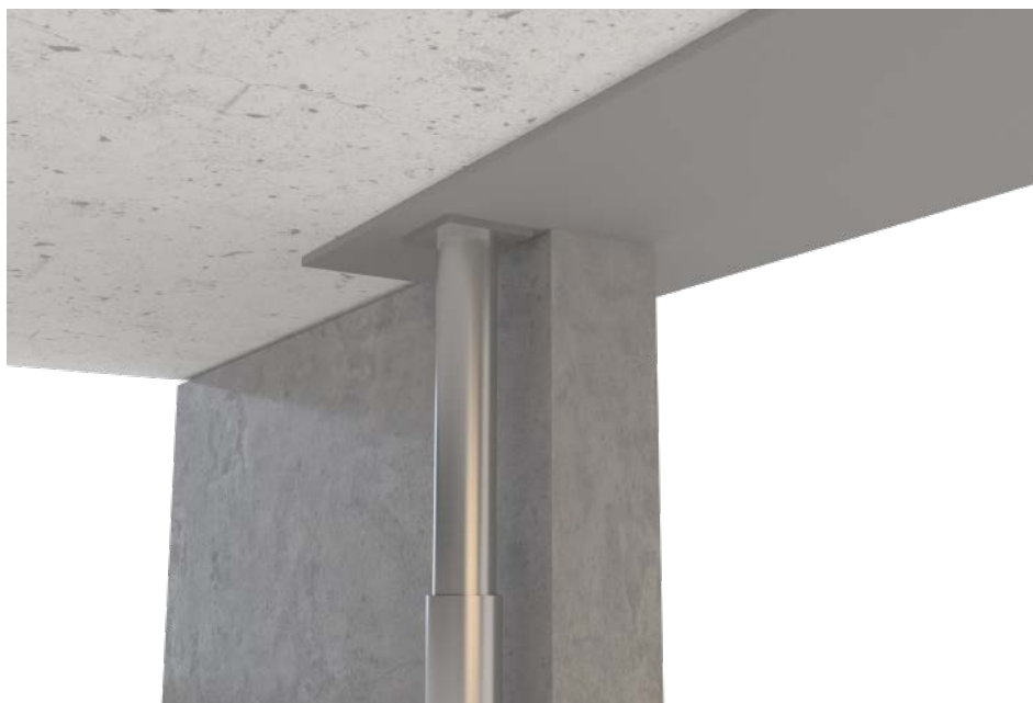
Rysunek 7. Stemplowanie gdy belka DELTABEAM® opiera się na końcu ściany.
