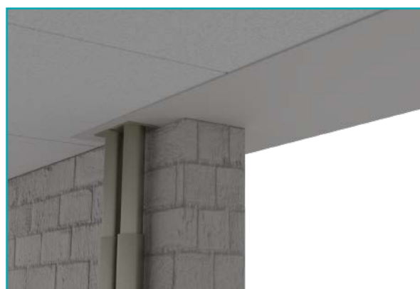
Stemplowanie przy oparciu na ścianie
