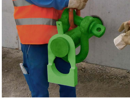
Kuva 23. Nostoraksi kiinnitettynä sakkeleilla.
