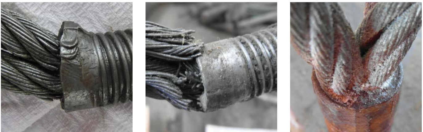
Kuva 29. Väätynyt holkki / katkenneet säikeet / ruostunut vaijeri ja holkki.
