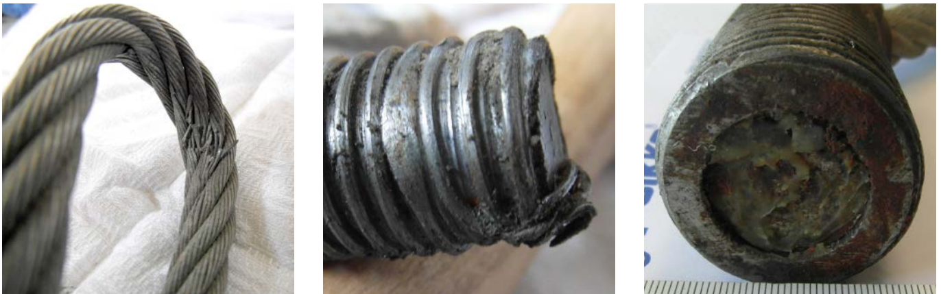
Kuva 28. Vaurioitunut vaijeri / vaurioitunut kierre / vaijerin säikeet ovat liukuneet.
