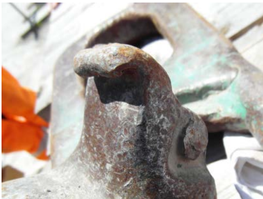
Kuva 36. Väätynyt KKL-nostolukko ja väsymismurtuma.
