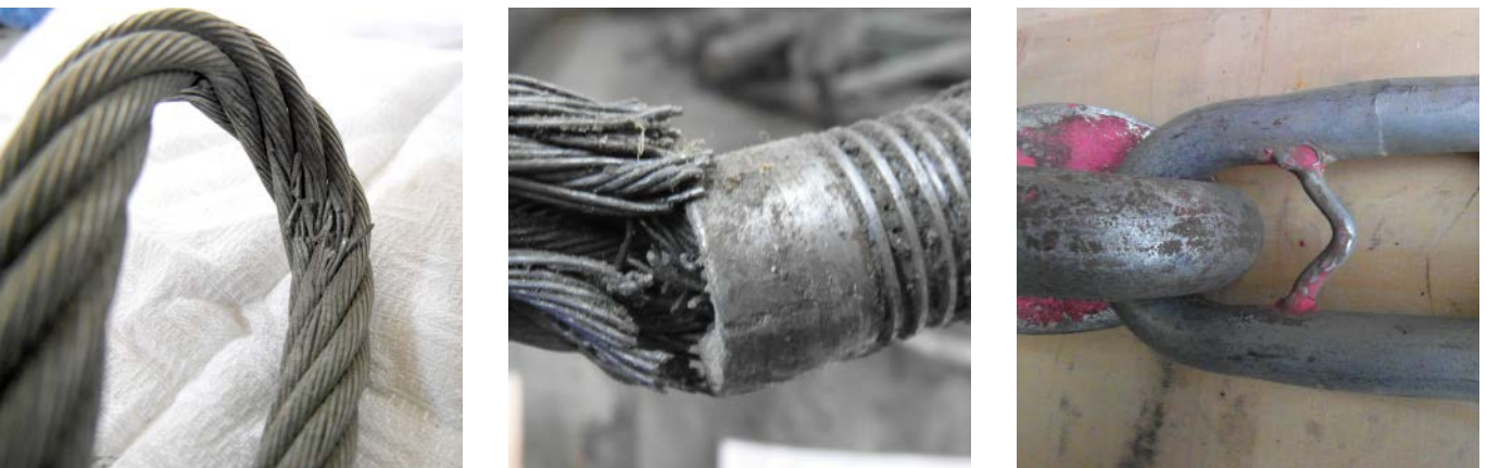
Kuva 32. Vaurioitunut vaijeri / katkenneet säikeet / vääntynyt nostorengas.
