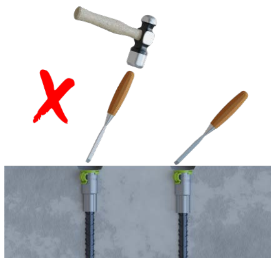
Figura 13. Modifiche dell'Inserito di Sollevamento JENKA.
