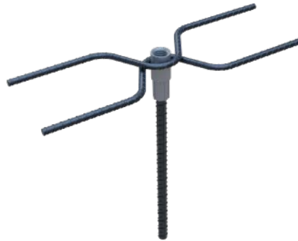
Barra singola = tiro laterale in una direzione Due barre = tiro laterale in due direzioni + tiro diagonale
