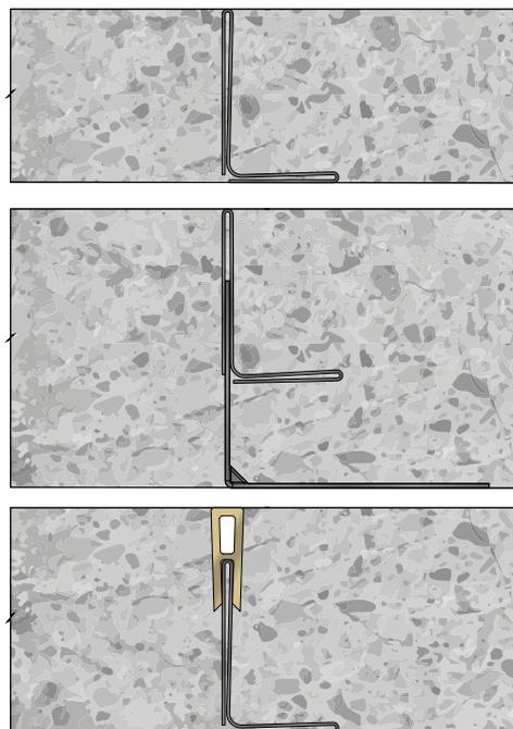
La guía de enrasado UNIRAIL® es un sistema eficiente producido con la última tecnología en acero de alta resistencia, que proporciona excelentes tolerancias y estabilidad durante la operación de enrasado. El sistema garantiza rectitud y altísima planimetría de las soleras con profundidades de 40 mm a 120 mm.
