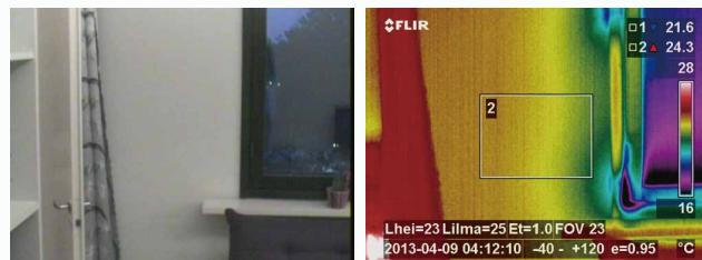
图8/9. 夹心保温外墙进行红外线成像测试
