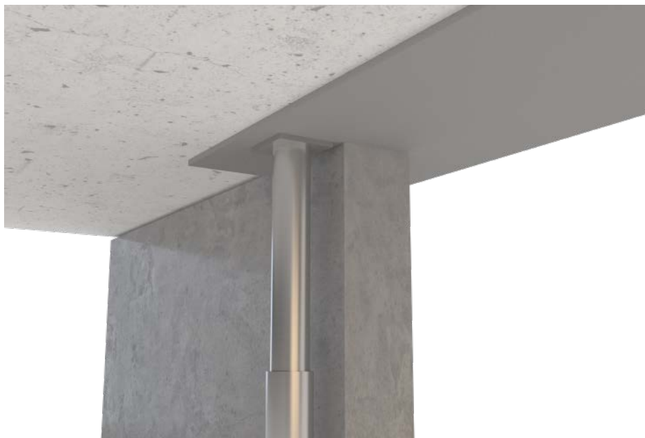
Figur 7. Stämning när DELTABEAM® är upplagd på väggens ände.
