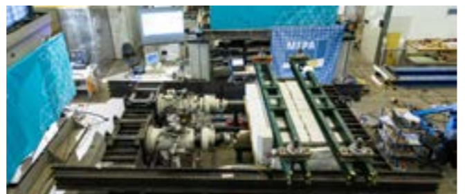
ABB. 5 – AUFBAU DER VERSUCHE AN EINZELPLATTEN; A) HEIZMATTEN, WÄRMEDÄMMUNG UND WIDERLAGERKONSTRUKTION WÄHREND DER MONTAGE; B) GESAMTANSICHT DES VERSUCHSAUFBAUS
