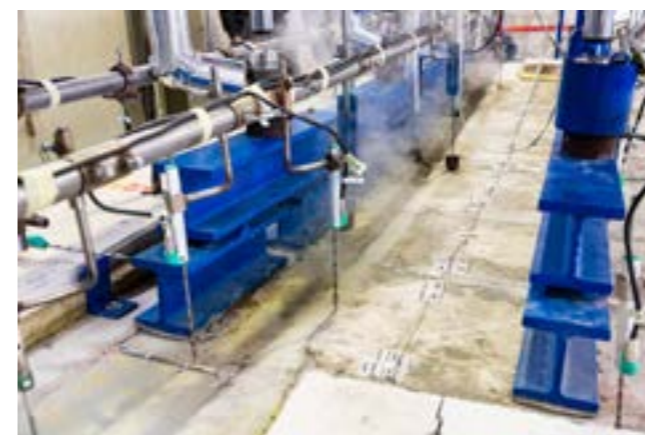
ABB. 8 – AUFBAU DER SYSTEM-BRANDVERSUCHE WÄHREND DER BEFLAMMUNG
